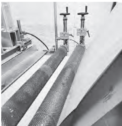
Bild 4: Endzustand mit verbauten Verstelleinheiten zur Regulierung der Andruckkraft
