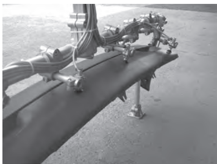
Entnahmegreifer für Kunststoffteile aus Klemmverbindern und Rohren Extraction gripping device for plastic parts, made of clamps and tubes
