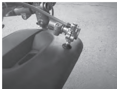
Entnahmegreifer für Kunststoffteile aus Klemmverbindern und Rohren Extraction gripping device for plastic parts, made of clamps and tubes
